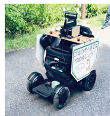
ステレオカメラを用いた電動車いすの自律走行実証 Autonomous driving demonstration of an electric wheelchair using a stereo camera
